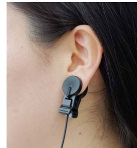
그림[2]. 귓볼에 센서를 장착한 모습
